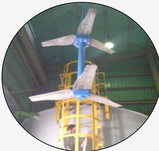
همزن پکیج فلوکولانت میدوک ۵.۵ کیلو وات ابعاد تانک: قطر ۳.۷ ارتفاع ۵ متر
